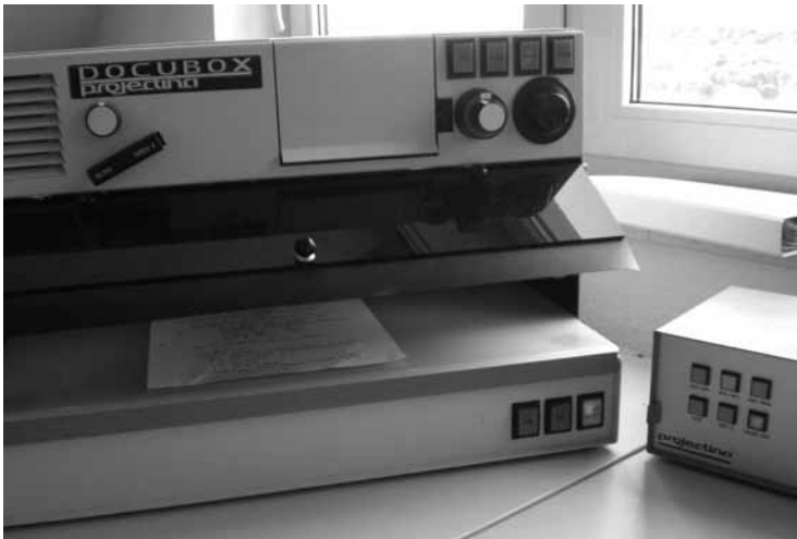
Abb. 10: Dokumentenprüfgerät mit unterschiedlichen Lichtquellen und Farbfiltern nebst eingebauter Kamera
