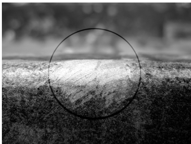
Abb. 3.2. Muster des Strangwerkzeugs in Form von Riefen im Handlauf des Geländers eines Bahnübergangs, Aufknüpfungspunkt mit doppelter Umschlingung
