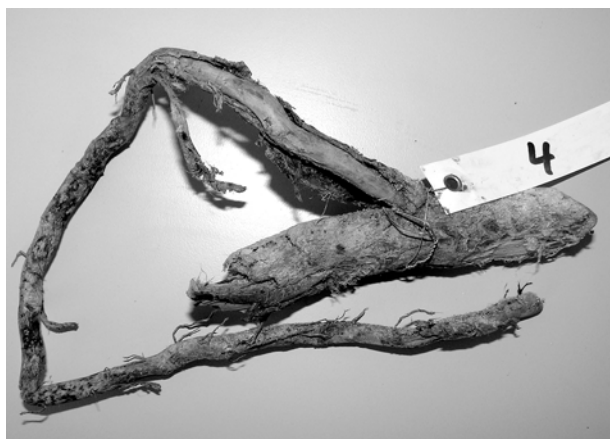
Abb. 16.2. Teil einer Baumwurzel, die zur Verstopfung eines Abflussrohres geführt hat
