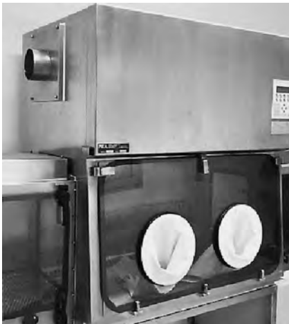
Abb. 5.18 Sicherheitswerkbank der Klasse III
